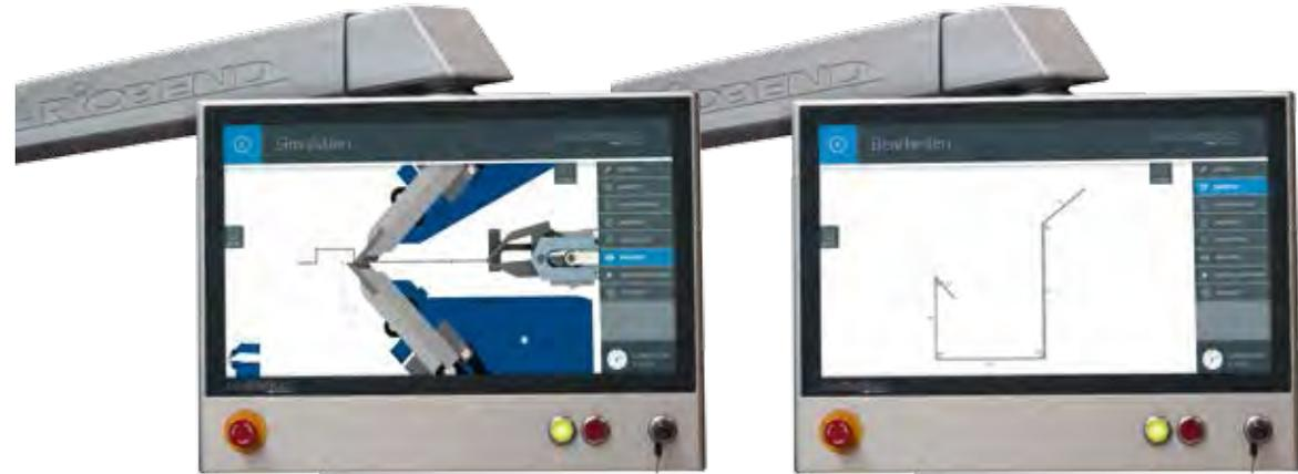
In der Simulation kann der komplette Biegeablauf auf Kollisionsfreiheit überprüft werden.
