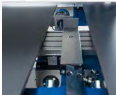
Hochfeste Wangensegmente, Steuerwellenantrieb, der optional erhältliche konische Tiefenanschlag auf Kugelumlaufspindeln für hohe Präzision, Servotechnologie, die standardmäßige Variobend Touch Control sowie der am Maschinenchassis befestigte Schneidapparat rund die Variobend ab.
