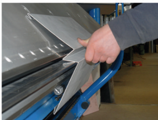
... und biegt es auf der 6-m-Variobend-Langabkantmaschine störungsfrei
