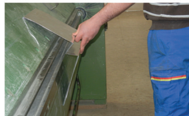
Die Wangengeometrie der alten Biegemaschine bereitete dabei immer wieder Probleme
